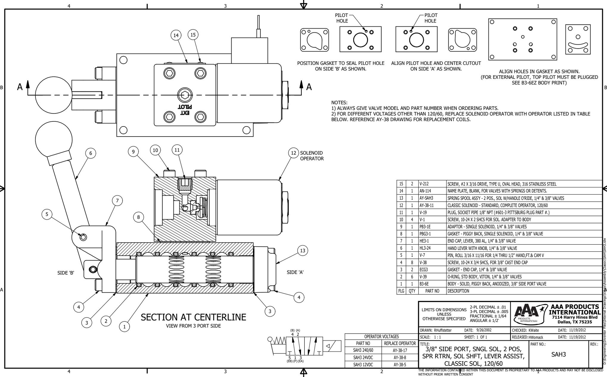
POSITION GASKET TO SEAL PILOT HOLE ON SIDE 'B' AS SHOWN.
